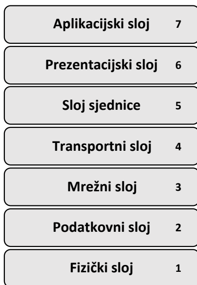
Slika 1. Slojevi OSI mrežnog modela
